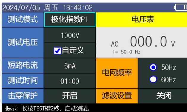
上下左右键可以控制显示界面光标位置，按下确认键可进入数值修改模式或直接修改参数设置。
