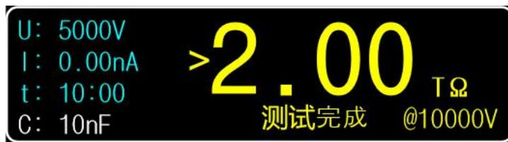
U：实时测量的输出直流电压值；
