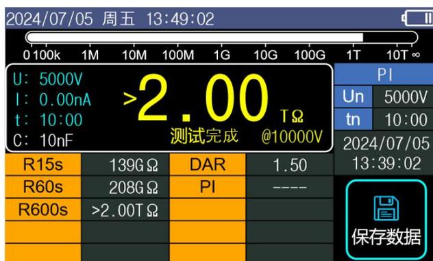
在此界面短按“测试”键或“电源/ESC”键将手动停止测试；长按“测试”键2秒将再次启动测试。在启动测试初期，高压电源处于软启动状态；在停止测试初期，仪器将对外部试品放电；此时状态指示灯为红色且快速闪烁，蜂鸣器发出急促的“哔…哔…哔…”讯响音。当进入正常测试状态时，状态指示灯为红色且每秒闪烁1次，蜂鸣器每秒发出1次“哔…”讯响音。
